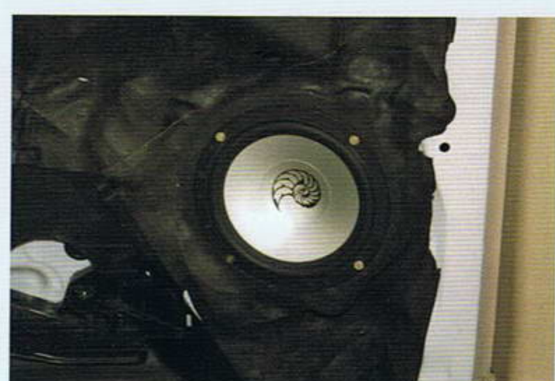
ลำโพง 6" MICRO PRECISION ติดตั้งได้ลงตัวในประตู
