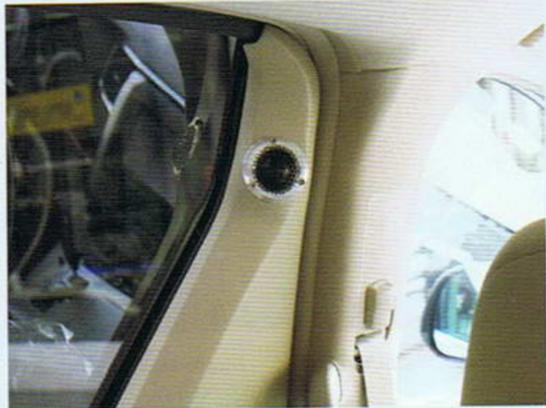
ลำโพง MICRO PRECISION ติดตั้งไว้ที่เสากลางของรถ
