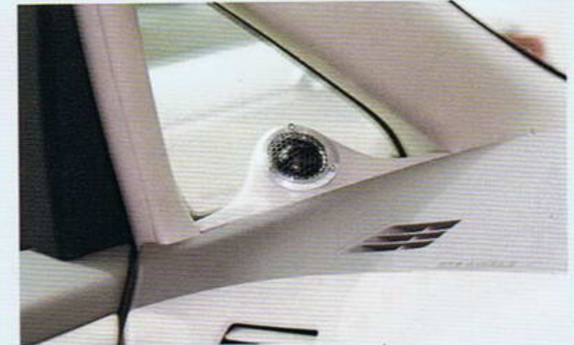
ทวีเตอร์ MICRO PRECISION S5 ปรับมุมยิงเสียง
